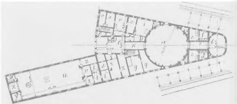
11. Чертеж железнодорожного вокзала города Казатина (построен в 1887–1891 годах): а=буфетный зал I и II классов, б зал I кл., в дамская уборная, д- клозет, е--мужская уборная, ф=клозет, г=помещение буфета, и=телеграф, к проход, л=багажный зал и кассы, м-багажная касса, н -билетная касса, о=кабинет и кантора начальника станции и дежурного по станции, р=хранение багажа, г почта, с=ламповая, т- медицинский персонал и приемный покой, и зал III кл., в буфет III кл., w- дамская уборная, х=умывальная, у–жандармская дежурная, z=проходы.
